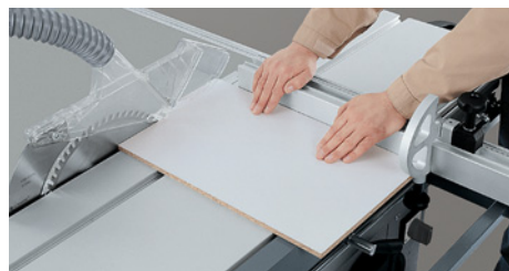
Оставшуюся часть заготовки обрезать на нужную длину, используя поперечный упор.
