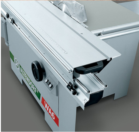
Знаменитая каретка Altendorf на стальных направляющих.
