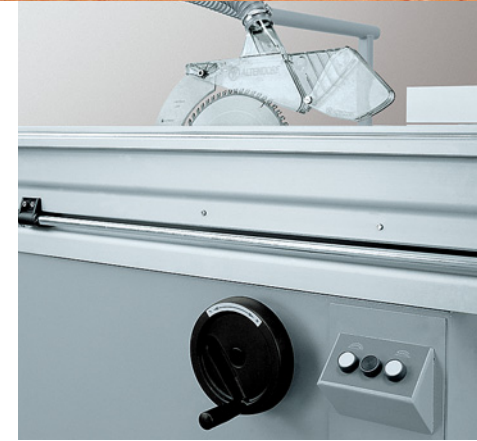
Ручная регулировка высоты пропила.
