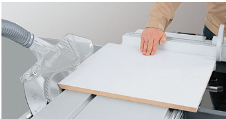
Установить пильный диск под желаемым углом, приложить заготовку к поперечному упору.
