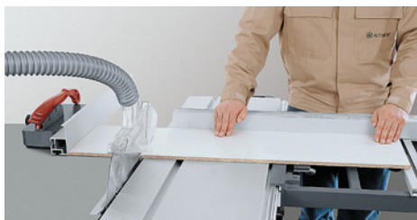
Используя продольный упор, раскроить заготовку на отрезки нужной длины.
