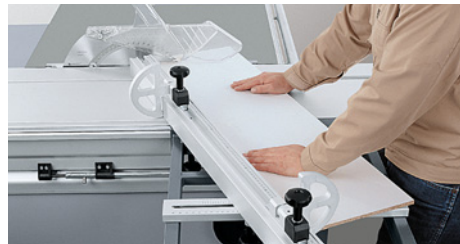
Непрямоугольные резы выполняются с использованием поперечного упора.
