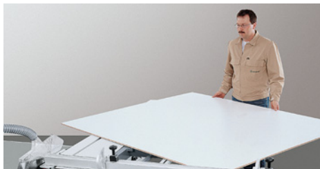
Повернув плиту в направлении против часовой стрелки, приложить её обрезанной стороной к поперечному упору.
