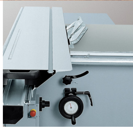
Ручная регулировка наклона пильного диска.
