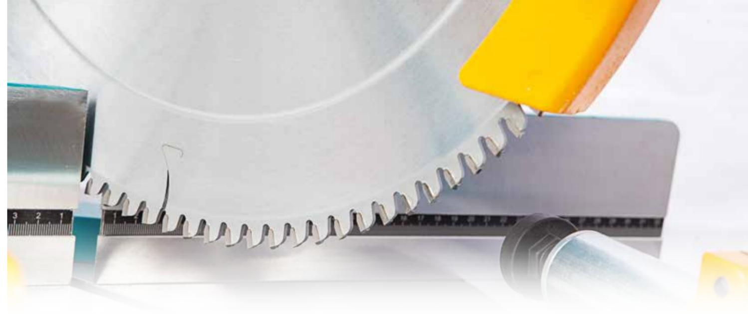
KD 400D ve KD 400P PVC, alüminyum ve ahşap profillerin düz ve dereceli kesme işlemleri için tasarlanmış kesme makinesidir.
