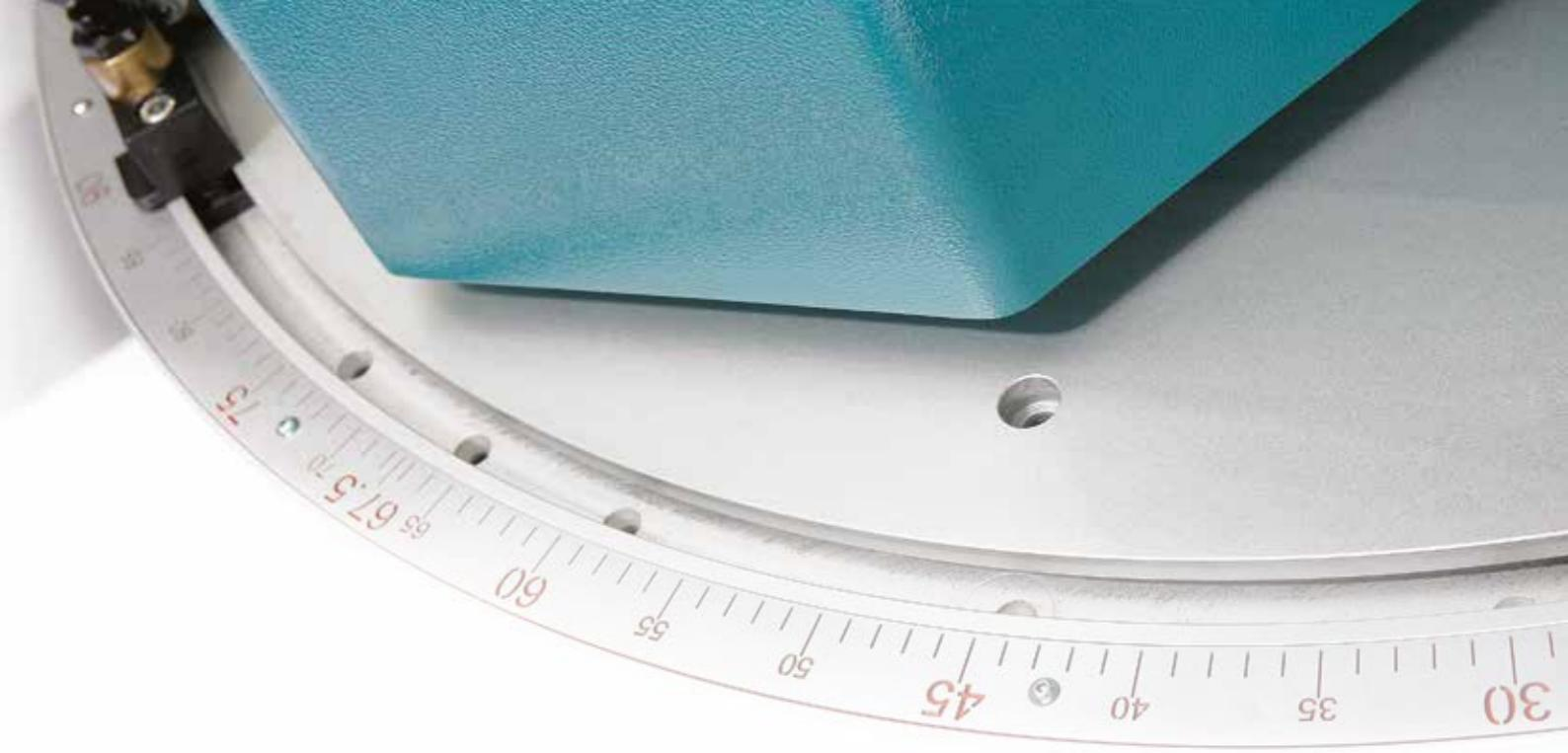
SC550 P geniş ebatlı PVC ve alüminyum profilleri, düz veya açılı olarak, tek kafa Ø550 mm testere ile kesmek amacıyla tasarlanmıştır, kesme makinesidir.
