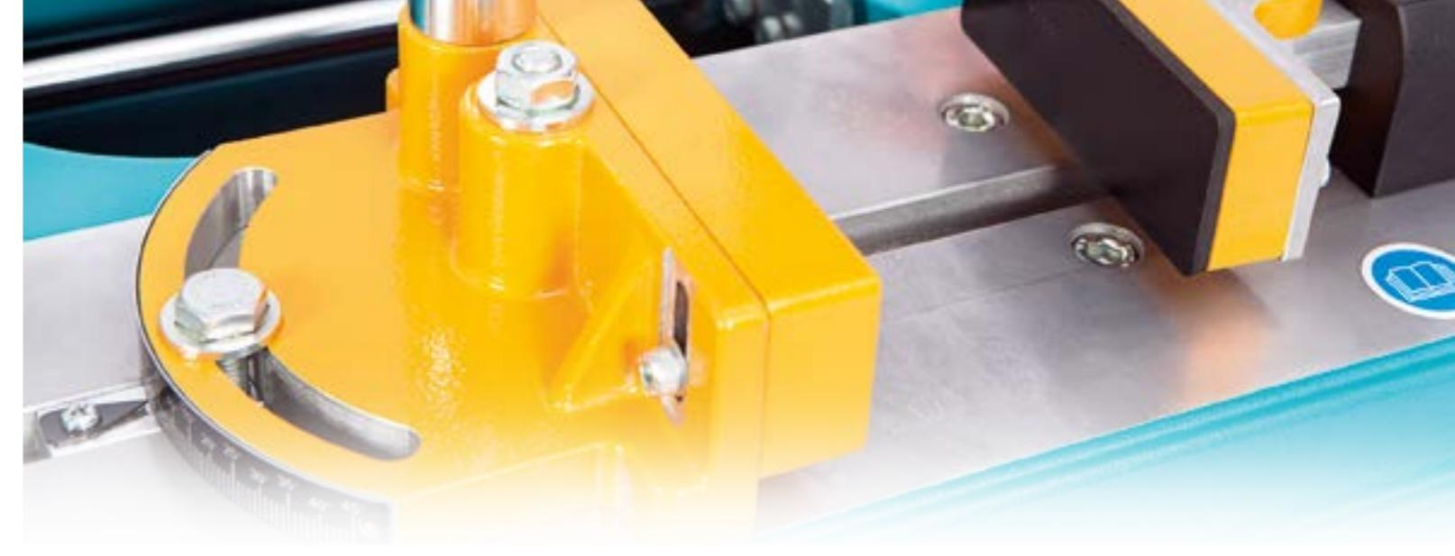
Alüminyum ve PVC profilleri hassas bir biçimde alıştırma işlemlerinde kullanılan Hidro-pnömatik olarak çalışan kertme makineleridir.
