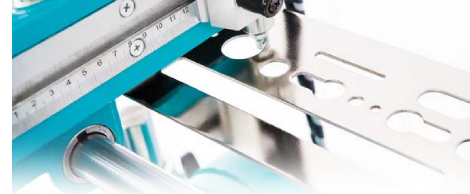
3 mm kalınlığa kadar Alüminyum ve PVC kapı ve pencere profillerindeki, barel yuvası delikleri, su tahliye kanalları, menteşe ve ispanyolet yeri gibi birçok frezeleme ve delik delme işlemleri için kullanılır.
