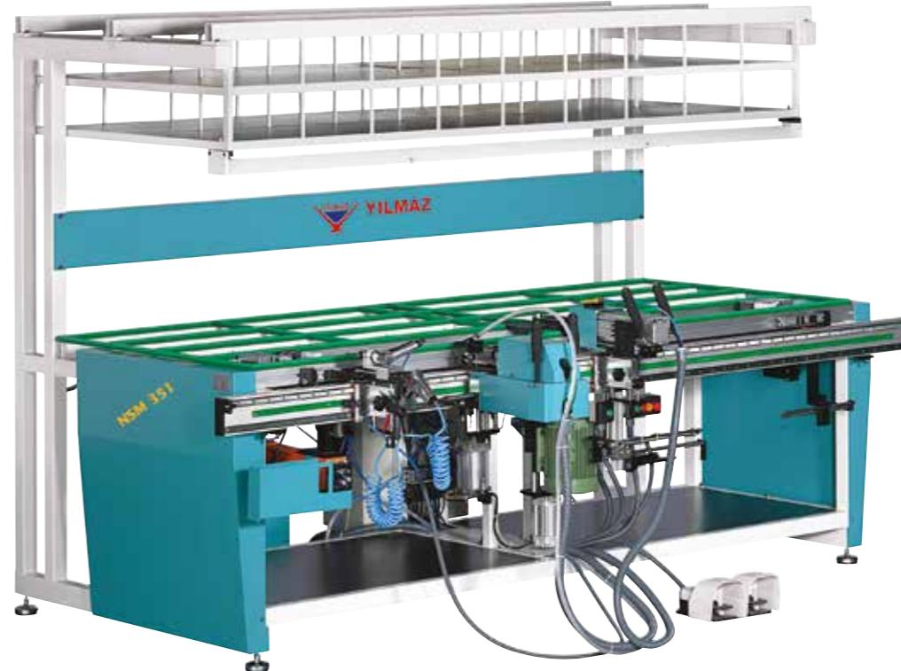
Farklı seri ve ebatlardaki pencere kanat profili üzerinde kullanılan tüm tek açılım ve çift açılım aksesuarlarının metre, kaleml, kalıp ve şablon kullanmadan seri bir şekilde kaliteli ve standartlara uygun olarak montajını sağlamak amacıyla kullanılır.
