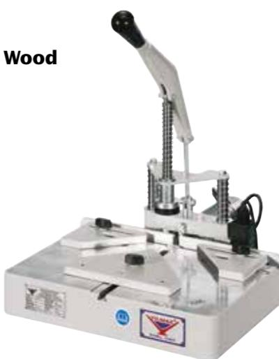
Ahşap profillerin köşe birleştirme kanallarını açar.
