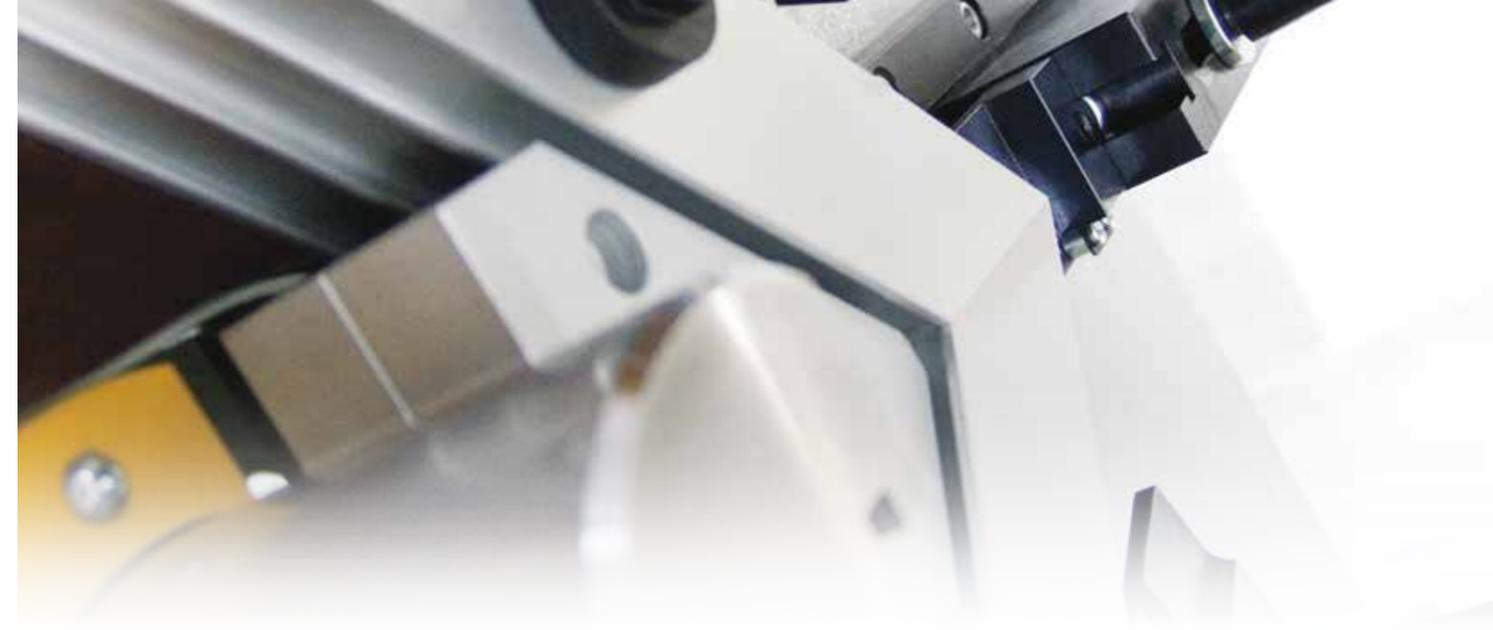
KP 120 alüminyum profillerin doğru bir şekilde köşelerinin hidrolik yolla preslenerek birbirlerine monte edilmesi amacı ile dizayn edilmiştir. Makine yarı otomatik ve manuel kontrollü olarak çalışmakta olup operatörün çalışma alanının dışında güvenli alanda tutulmasına dikkat edilmiştir.
